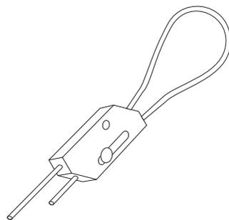
LE GRIPPLE® PERMET UN RÉGLAGE FACILE ET SÛR EN HAUTEUR
