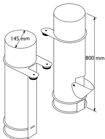
n 145 105 Transparent - Hauteur 800 mm - Diamètre 145 mm
